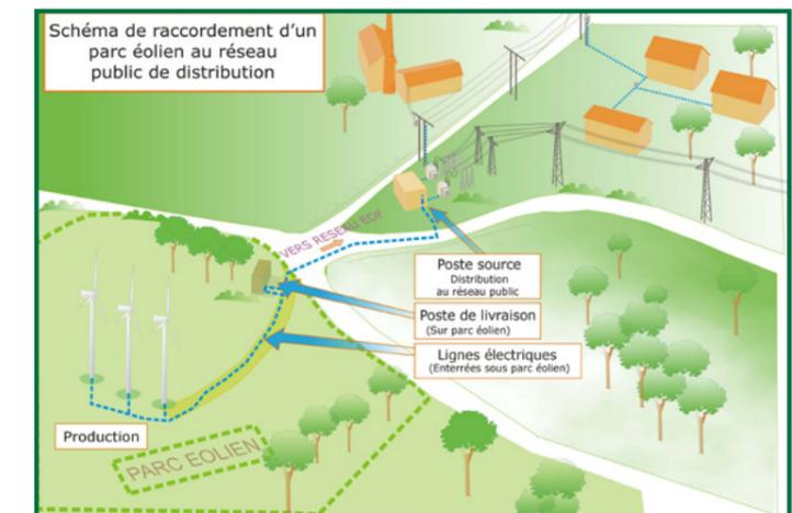
Schéma du raccordement d'un parc éolien au réseau public de distribution
